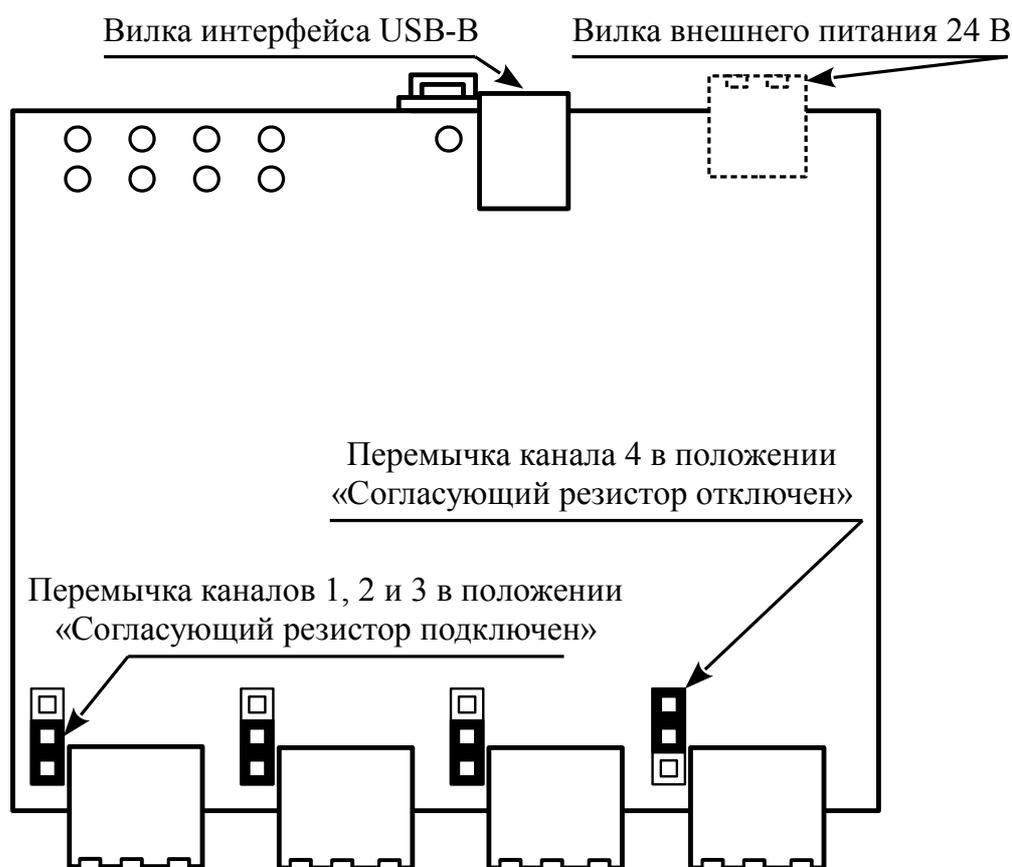
Рисунок 6 - Расположение переключателей для подключения согласующих резисторов
