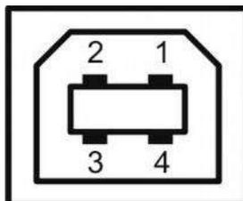
Рисунок 2 – Расположение контактов вилки интерфейса USB
