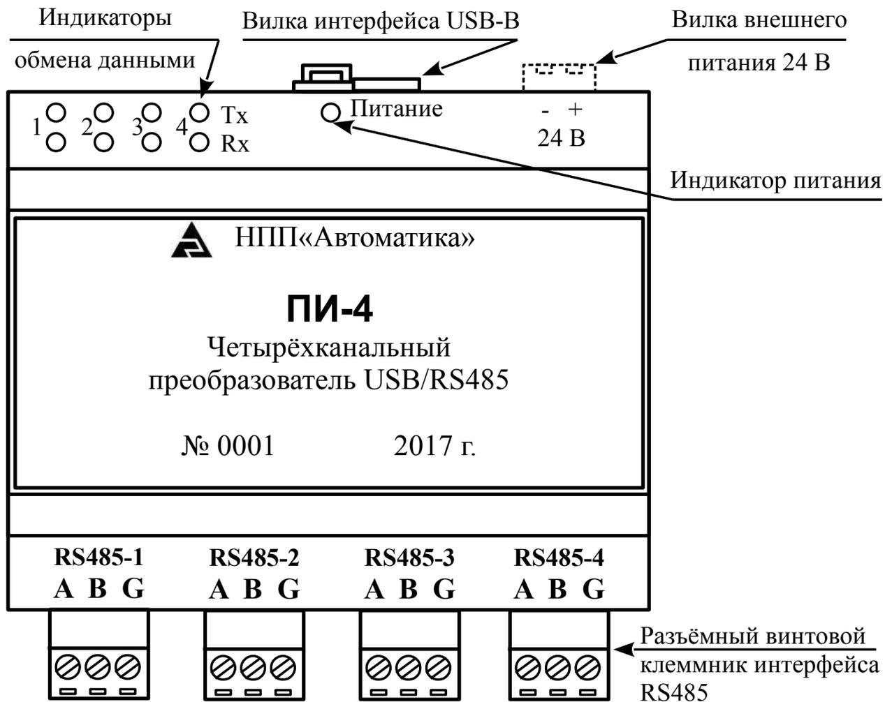
Рисунок 5 - Расположение индикаторов и разъёмов
